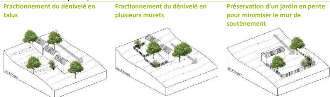
Image 14 - Illustration de minimisation des terrassements dans les terrains en pente
